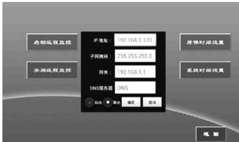
图 17 设备 IP 静态地址设置
