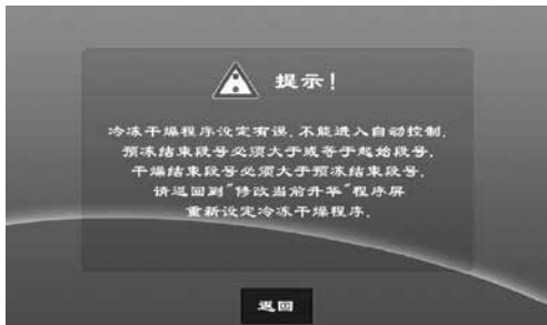
图 14 “冷冻干燥程序设定有误”提示窗
