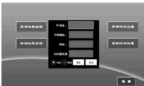
图 18 设备 IP 动态地址设置
