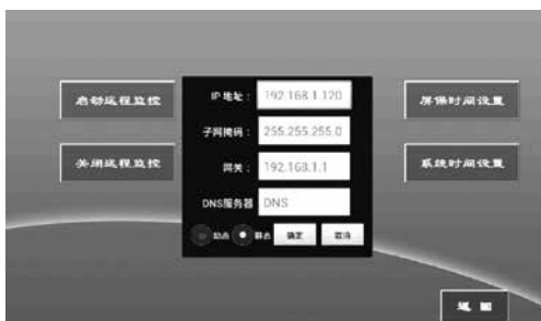
图 17 设备 IP 静态地址设置
